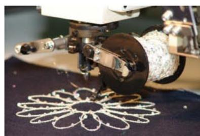
4 Šūšanas process (šajā gadījumā tiek izmantota spīrālveida izšūšanas tehnika).
