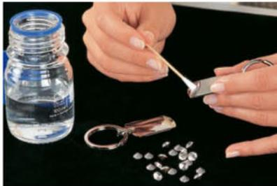
1 Pirms līmēšanas, virsma ir pareizi jāapstrādā (piem. tīrīšana, attaukošana, abrazīvā apstrāde). Ja izmantojat šķīdinātāju, uzgaidiet dažas minūtes, ļaujot tam iztvaikot.
