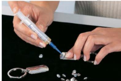
2 Ja līmes tūbiņai pašai nav piemērotas sprauslas, līmi vajadzētu uzlikt ar dozētāja palīdzību. Lai līmētu vienā punktā, novietojiet adatu tieši virs šī punkta, izspiediet nedaudz līmes un lēnām attāliniet sprauslu virzienā uz augšu, lai izvairītos no līmes izsmērēšanās uz sāniem.
